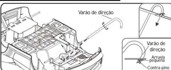
Varão de Direção. Vire o veículo ao contrário, introduza o varão de direção no orifício frontal do corpo até atravessá-lo no painel. Encaixe a ponta curvada do varão de direção no orifício do jogo de direção conforme imagens ao lado. Coloque uma arruela pequena na extremidade do varão e então introduza o contra-pino. Para finalizar dobre as pontas do contra-pino com um alicate.
