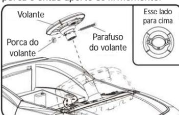
**Troca de Pilhas do Volante.** Remova o parafuso da tampa do volante e retire a mesma, coloque duas pilhas AA, então coloque novamente a tampa da bateria.
