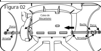
**Rodas Dianteiras.** Introduza uma arruela grande e a seguir uma bucha em uma roda livre. Encaixe uma roda livre no eixo, então introduza outra arruela grande no eixo. Aperte a porca com a chave fixa. Por fim encaixe as calotas em todas as rodas do produto.
