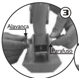
3. Afrouxe o parafuso da alavanca da base dianteira do guidão girando-o no sentido anti-horário e abra a alavanca.
