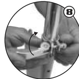
8. Gire e aperte o parafuso no sentido horário e feche a alavanca da abraçadeira, fixando a abraçadeira firmemente.
