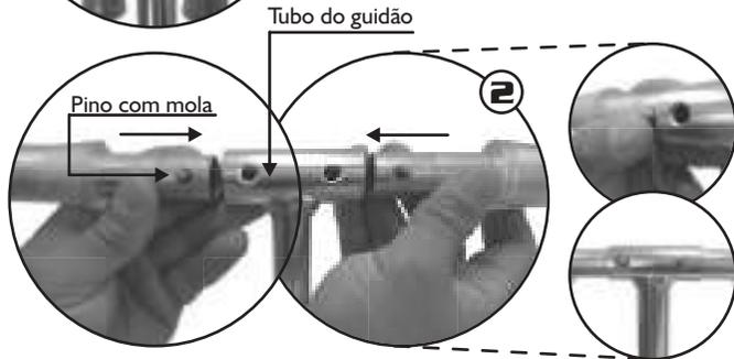
2. Encaixe os tubos da manopla no tubo do guidão, pressionando os pinos com mola e alinhando-os de forma que encaixem nos orifícios do tubo e fiquem travados.
