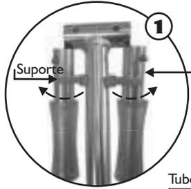
1. Desencaixe os tubos das manoplas do suporte, conforme indicado na imagem ao lado.
